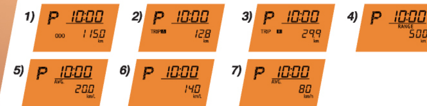
จอแสดงข้อมูลการขับขี่ Multi Information Display (MID) แสดงข้อมูลในการขับขี่ 1. ระยะทางรวม 2. Trip A 3. Trip B 4. ระยะขับได้จากน้ำมันที่เหลืออยู่ 5. อัตราการใช้ น้ำมันเฉลี่ย 6. อัตราการใช้ น้ำมันในขณะนั้น 7. ความเร็วเฉลี่ย
